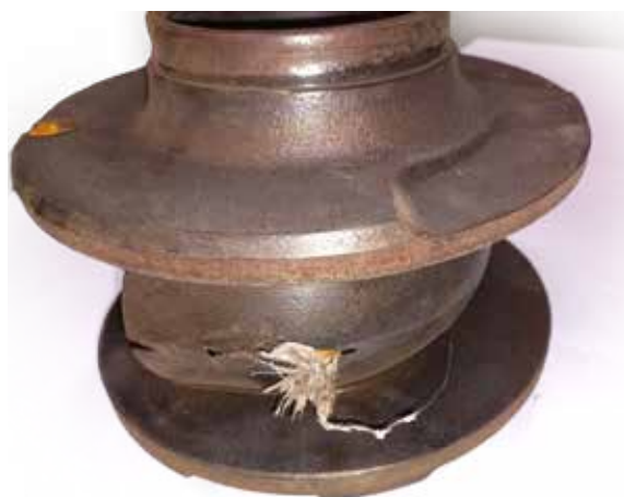
FOT. 2 Asymetryczne zużycie wirnika jednołopatkowego poprzez całkowite przetarcie łopatki
