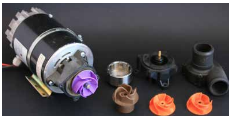
FOT. 8 Wirnik zabudowany na sprzęgle badanej pompy, obok wirnik oryginalny (brązowy) oraz wariantowe (pomarańczowe). W tle sprzęgło magnetyczne i oryginalny kadłub
