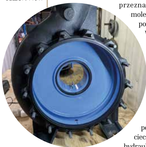
FOT. 1 Korpus pompy wirowej po nalożeniu powłoki kompozytowej BELZONA 1341
