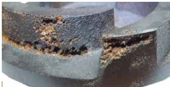
FOT. 1 Uszkodzenia kawitacyjne wirnika pompy promieniowej (źródło: M. Bańczyk, Optymalizacja numeryczna (CFD) geometrii wirnika w pompie wirowej , Praca magisterska Politechnika Krakowska, 2024)
