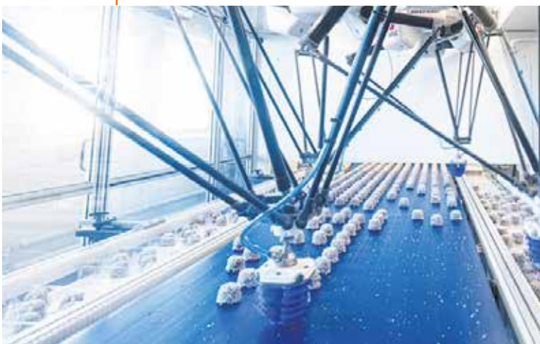
FOT. 2 Robot ABB typu delta IRB 360 FlexPicker [7]
