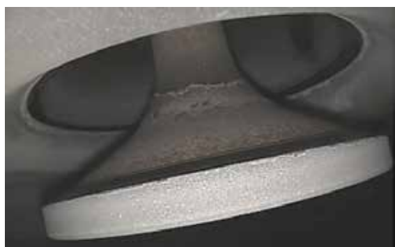
FOT. 2 Zdjęcie z boroskopii silnika – zawór i gniazdo zaworowe (źródło: materiały Goodvalley)
