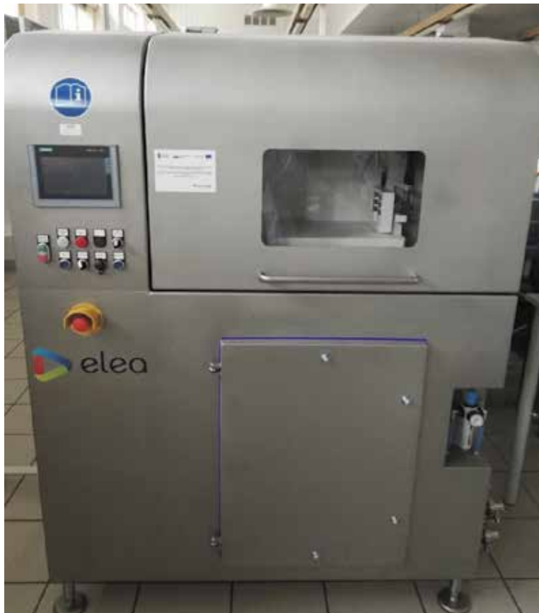
FOT. 3 System do okresowego aplikowania pulsacyjnego pola elektrycznego (PEFPilot™ Dual System, Elea Vertriebs- und Vermarktungsgesellschaft mbH, Quakenbrück, Niemcy) znajdujący się na Wydziale Technologii Żywności Szkoły Głównej Gospodarstwa Wiejskiego w Warszawie, funkcjonujący w ramach Centrum Badawczo-Rozwojowego Żywności i Żywnienia (CZiŻ) (źródło: zasoby własne autora)
