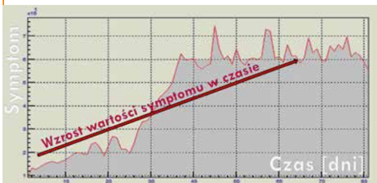
RYS. 6 Trend symptomu wskazującego na możliwość kawitacji (źródło: zasoby własne autora)
