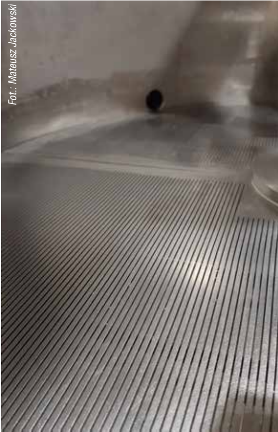
FOT. 1 Perforowane dno kadzi filtracyjnej zwane również fałszywym dnem
