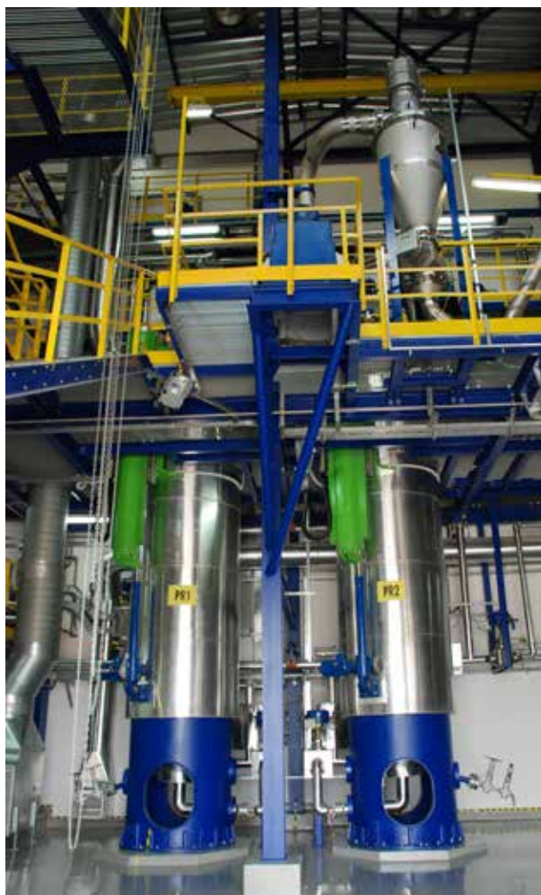
FOT. 1 Instalacja do ekstrakcji nadkrytycznym CO 2 znajdująca się w Łukasiewiczu – Instytucie Nowych Syntezy Chemicznych w Putawach (źródło: Andrzej Furda)
