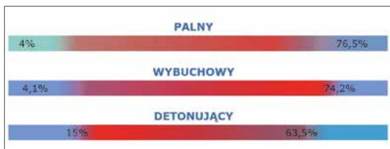
RYS. 1 Reakcje palne w zależności od stężenia wodoru w powietrzu (źródło: zasoby autora)
