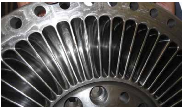
FOT. 1 Wirnik wykonany w technologii proponowanej przez P.B.W. HYDRO-POMP
