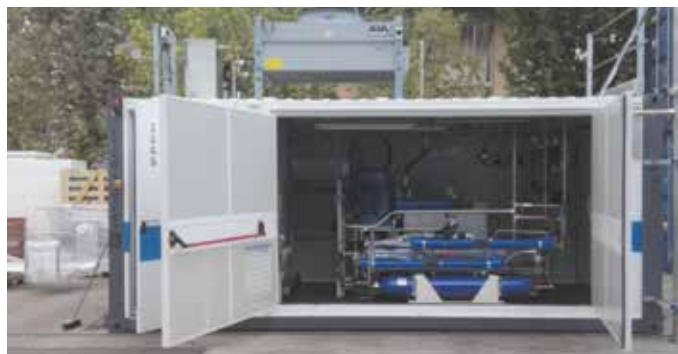
FOT. 3 i 4 Sprężarka wodoru firmy Idro Meccanica
