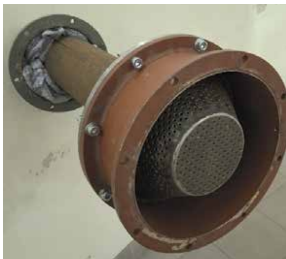
FOT. 2 Zamontowany w komorze pogłosowej, na wylocie ze stoiska, model rozprężacza o średnicy otworów sita równych 6 mm
