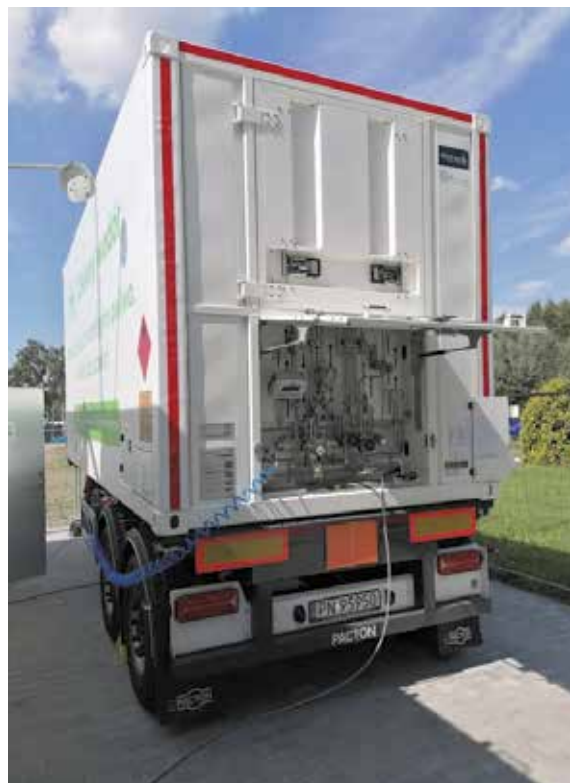
FOT. 5 i 6 Mobilny magazyn wodoru o pojemności 371 kg H 2 (MEGC) – widok na część z zaworami; widok wewnętrzny z butlami wodorowymi
