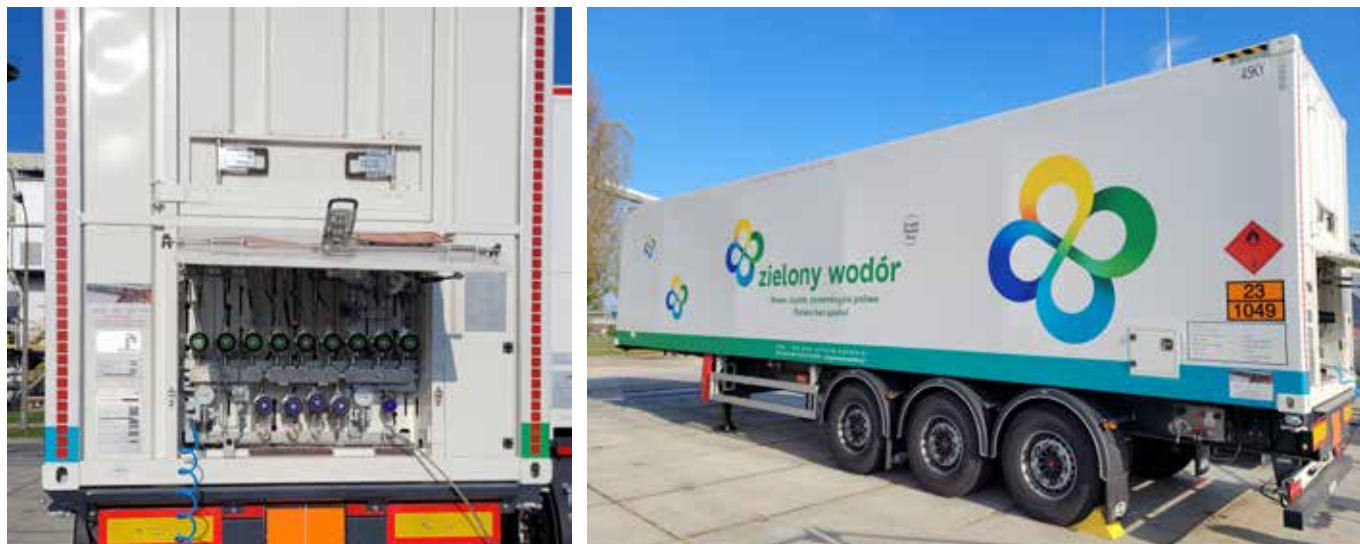
FOT. 7 i 8 Mobilny magazyn wodoru o pojemności 1080 kg H 2 (MEGC) – widok na część z zaworami; widok z boku
